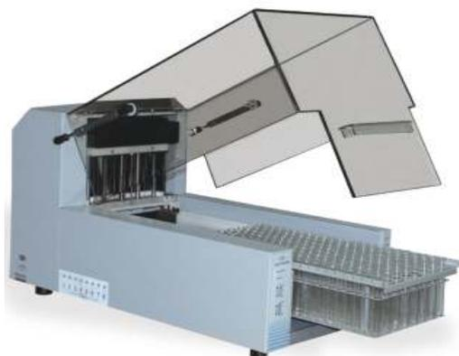
x-y 臂式移动能够满足所有自动取样要求，如收集、混合，抽吸和稀释样品。
